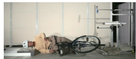
ヘルメット着用の有効性に関する検証実験の様子（実験映像）
